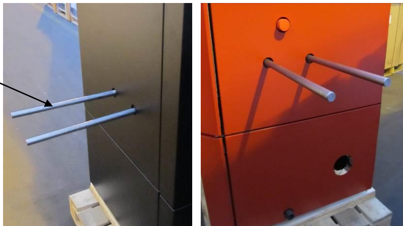
Slika.1 Manipulisanje kotlom pomoću nosača
