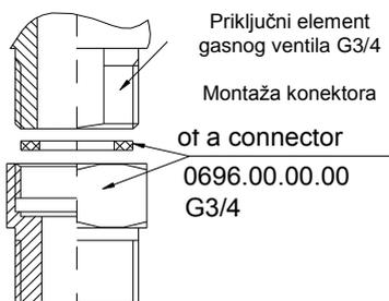
Dovodnu cev gasovoda povežite direktno na priključak gasne jedinice pomoću podsklopa br 0696.00.00.00. na način prikazan na slici 3.4.1.
