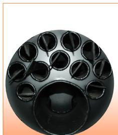
Cijevni izmjenjivač topline je konstruiran sa turbulatorima, koji smanjuju brzinu izlaznih plinova, a ujedno povećavaju površinu preko koje se prenosi toplina.
