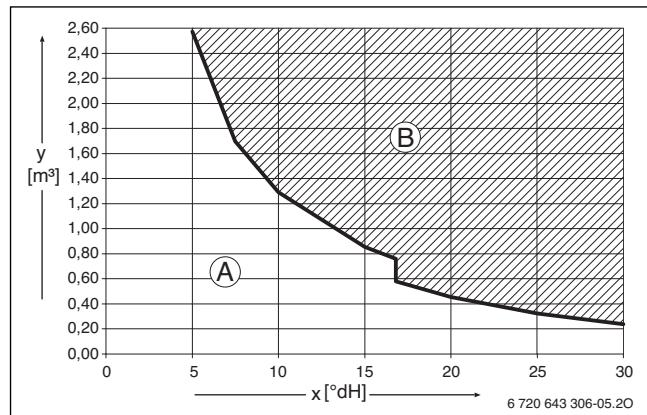
sl. 18 Zahtevi za vodu za punjenje i dopunjavanje uređaja u  $^{\circ}\text{dH}$  za uređaje  $< 50 \text{ kW}$
