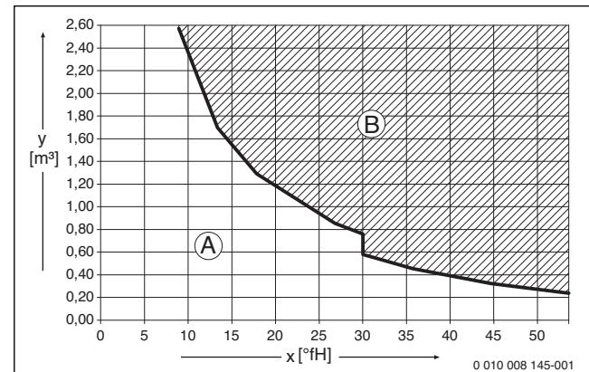
sl. 19 Zahtevi za vodu za punjenje i dopunjavanje uređaja u  $^{\circ}\text{fH}$  za uređaje  $< 50 \text{ kW}$
