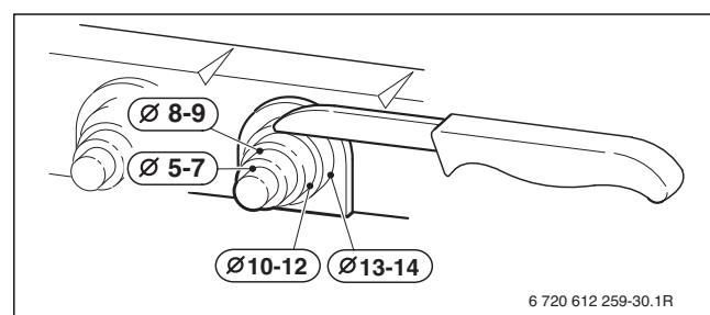
sl. 29 Prilagođavanje vučnog rasterećenja prečniku kabla
