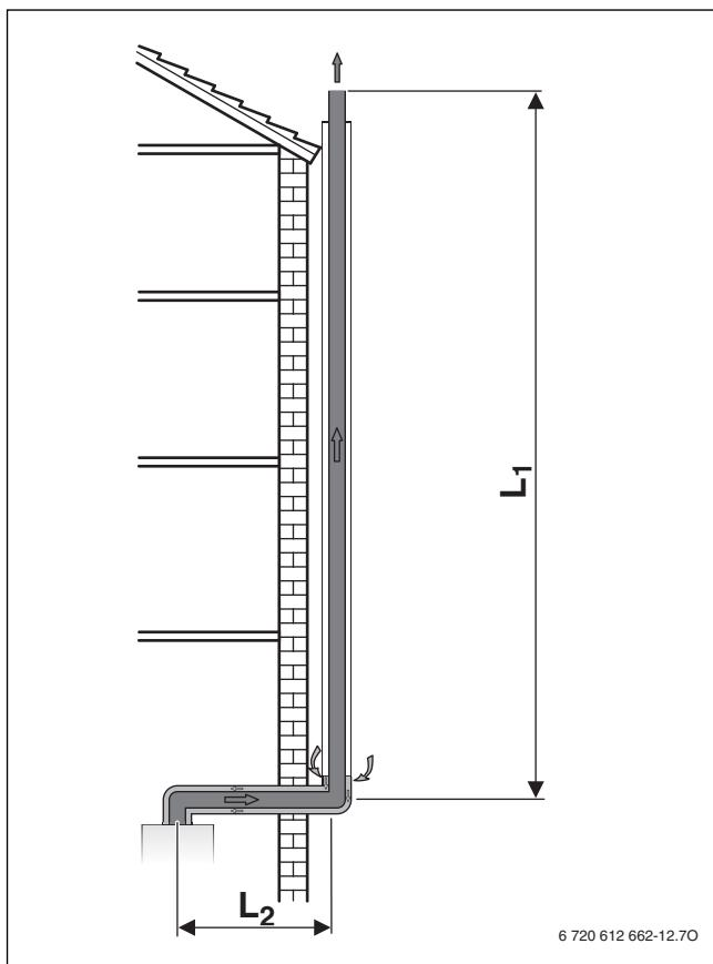
sl. 16 Odvod izduvnih gasova na fasadi prema C<sub>53</sub>
