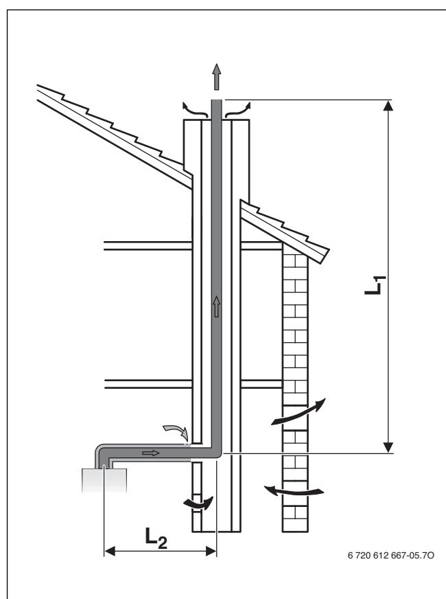
sl. 8 Odvod za izdavnne gasove u šahti prema B<sub>33</sub>
