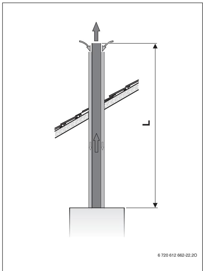
sl. 14 Vertikalni odvod izduvnih gasova prema C<sub>33</sub>
