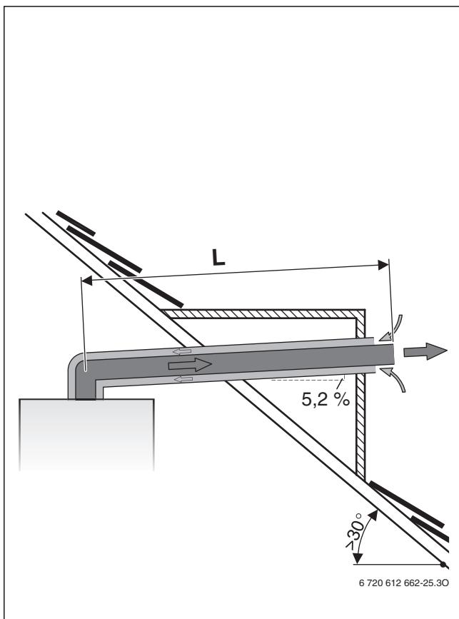
sl. 12 Horizontalni odvod izduvnih gasova prema C<sub>13</sub>
