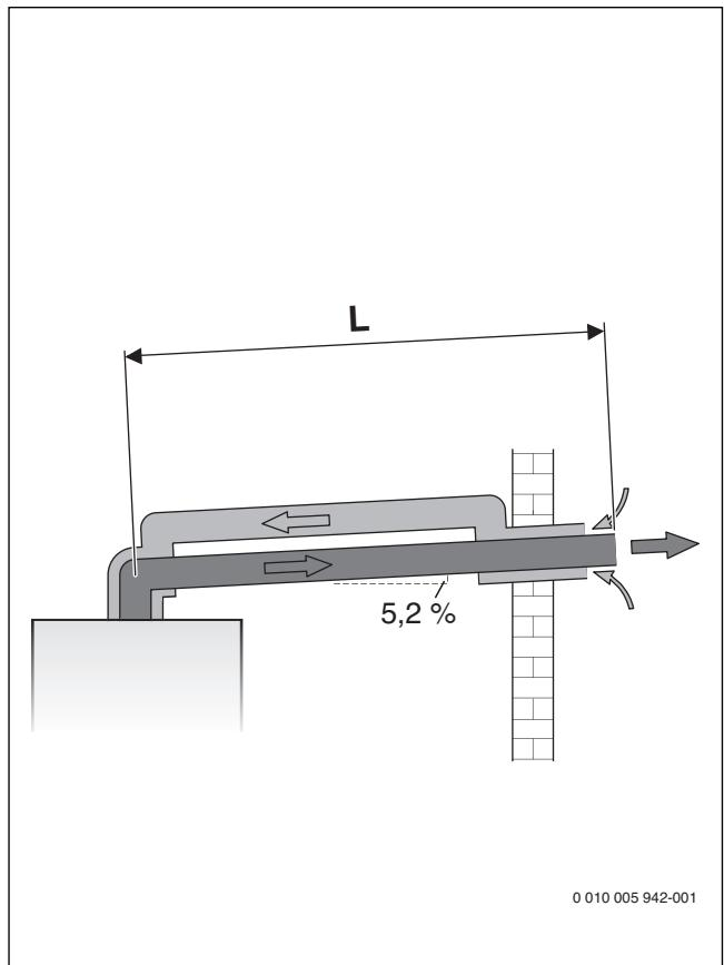
sl. 13 Horizontalni odvod izduvnih gasova prema C<sub>13</sub>
