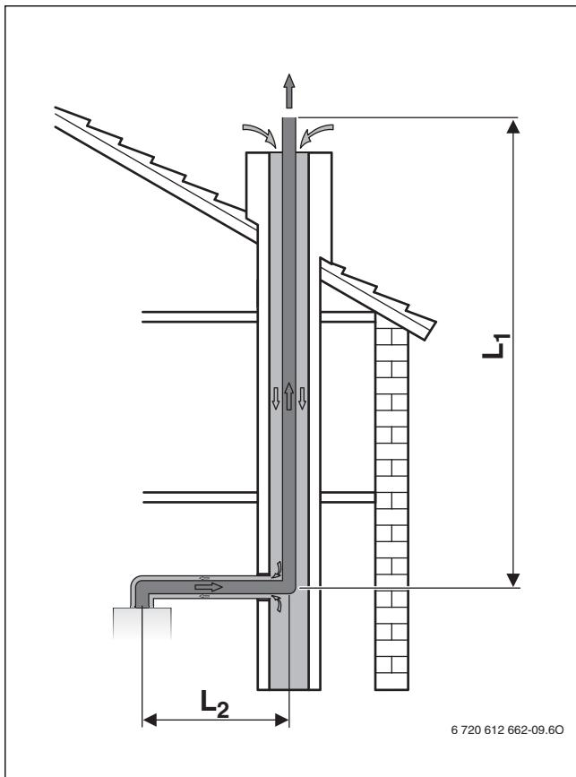
sl. 11 Odvod za izduvne gasove u šahu prema C<sub>93</sub>
