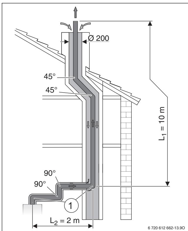
sl. 17 Situacija ugradnje odvoda izduvnih gasova u šahu prema C<sub>93</sub>
