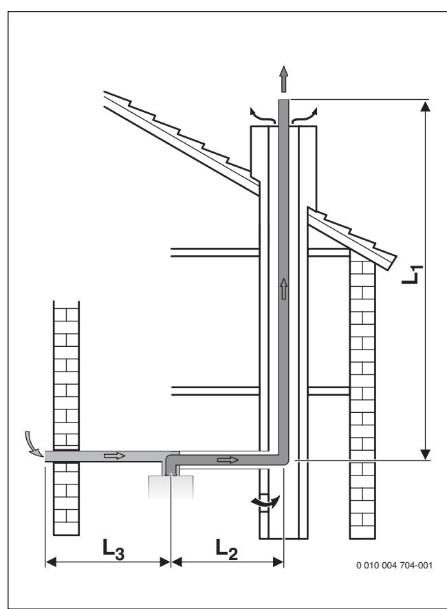
sl. 10 Odvod za izdavnne gasove u šahtu prema C<sub>53</sub>
