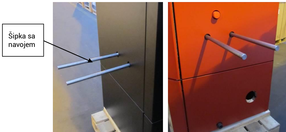
Slika. 1 Manipulisanje kotlom pomoću nosača
